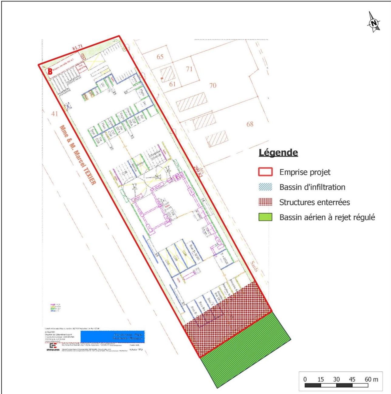
Figure 14 : Implantation sommaire des dispositifs pluviaux
